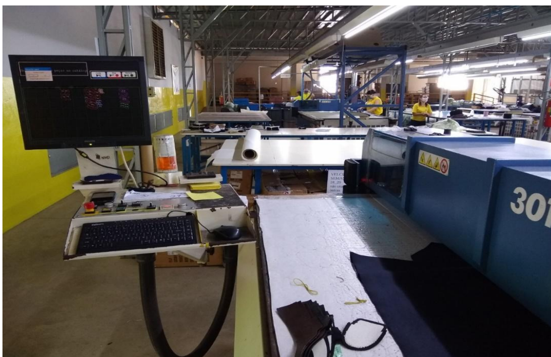
Foto 04 – Mesa de corte automatizada
