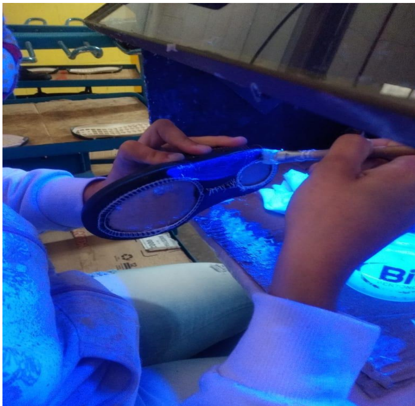
Foto 15 – Operação de unir solado ao cabedal.
