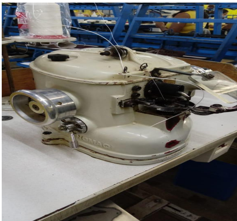
Foto 13 – Máquina de Montar o bico do calçado.
