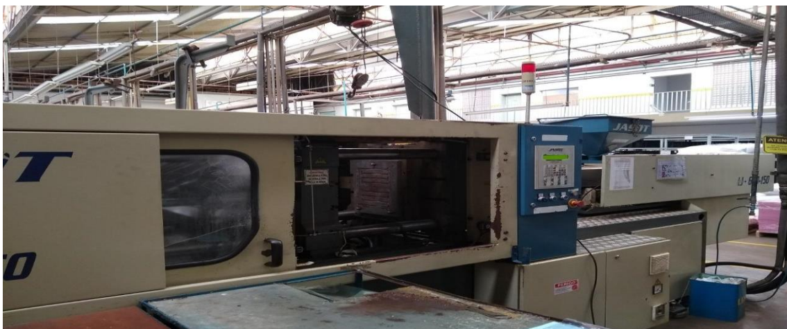
Foto 08 – Máquina Injetora para solado monocolor
