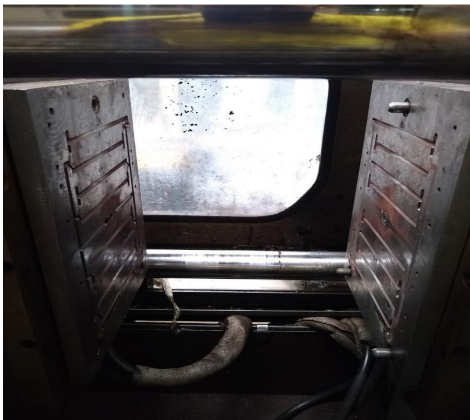
Foto 10 – Máquina Injetora para solado bicolor
