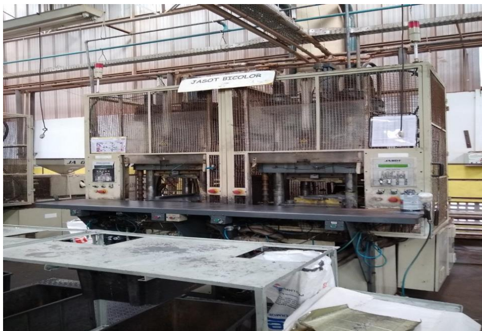
Foto 10 – Máquina Injetora para solado bicolor
