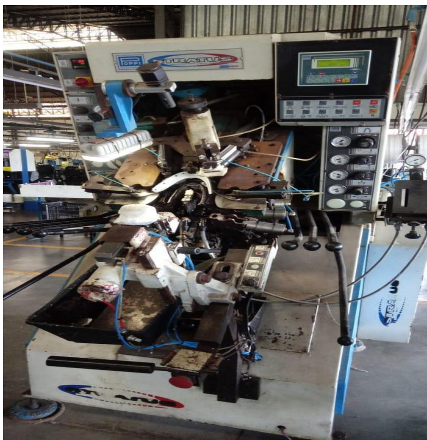
Foto 13 – Máquina de Montar o bico do calçado.
