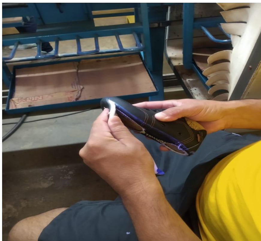
Foto 15 – Operação de unir solado ao cabedal.
